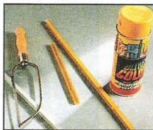
Профили раскраивают лобзиком по длине, зашлифовывают «на ус» и покрывают лаком.
