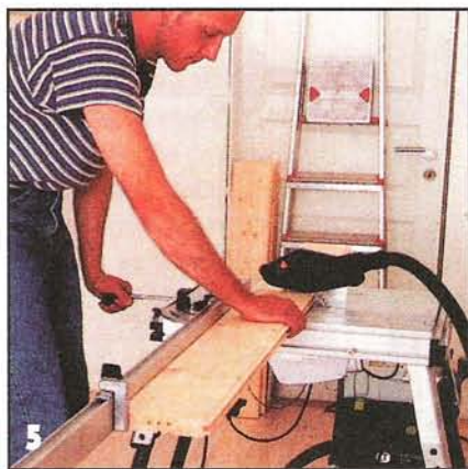
Настольная дисковая пила позволяет раскраивать вагонку даже в пакетах из двух досок.
